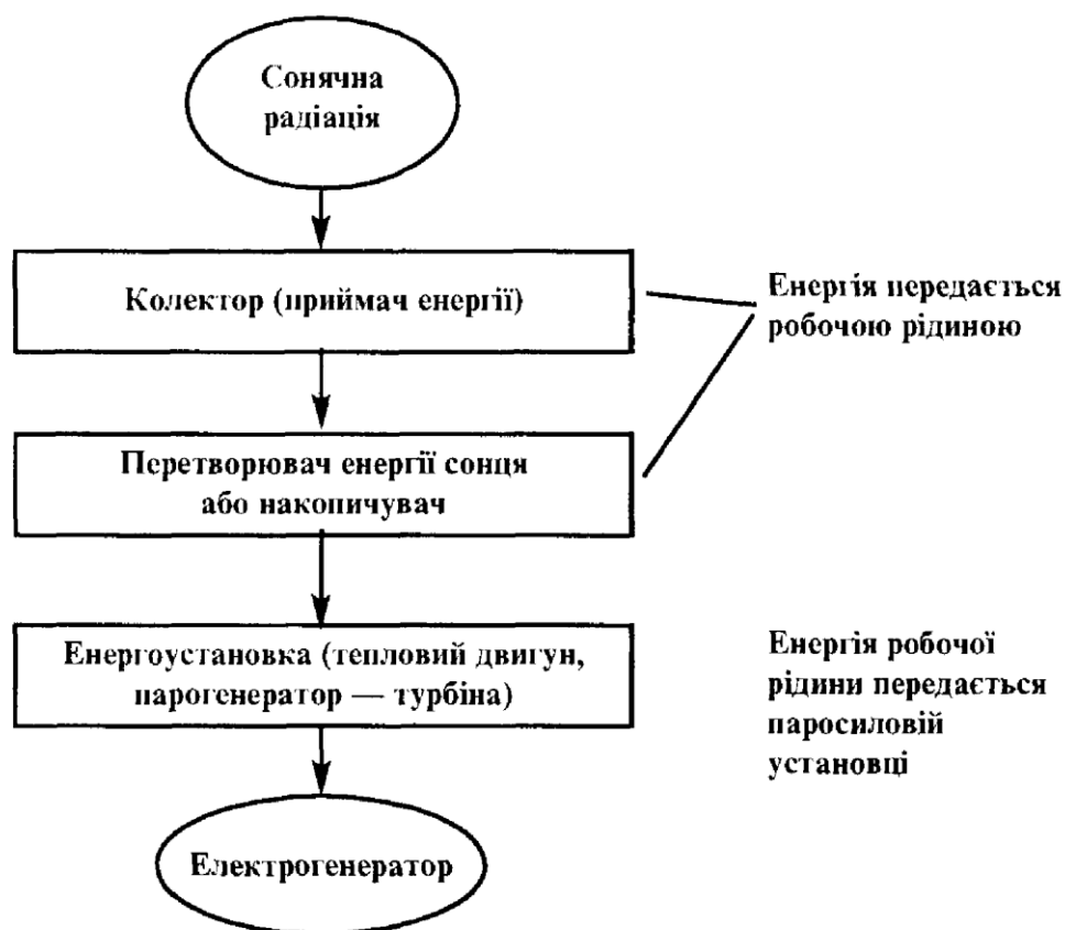
Рис.2.27 Принципова схема геліоенергетичної установки
