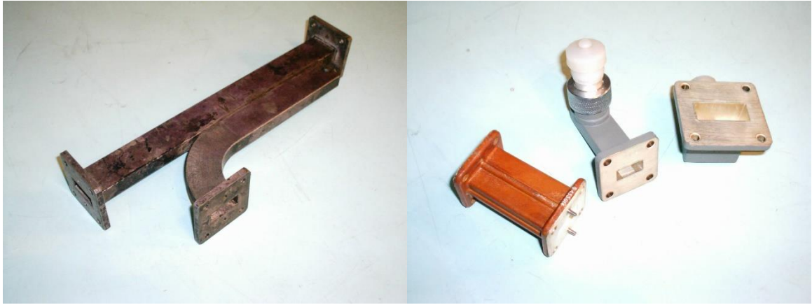
Рисунок 3.5 - Зовнішній вигляд деяких елементів хвилеводних трактів мікрохвильового діапазону
