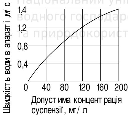
Рис. 3.19. Залежність допустимої концентрації суспензії в охолоджуючій воді від швидкості руху води в теплообмінних апаратах
