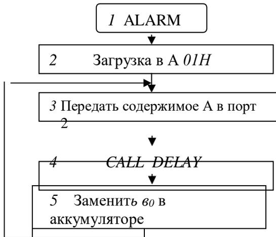
Рисунок 14.5- Блок-схема алгоритма решения задачи
