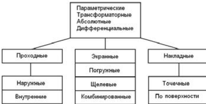
Рис. 1.15. Типы вихретоковых преобразователей
