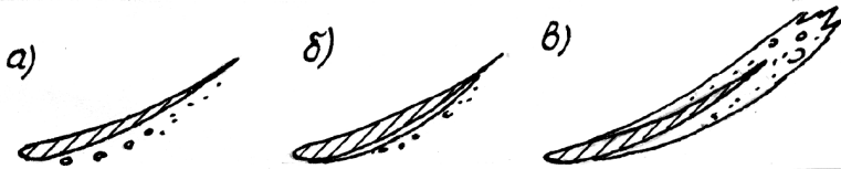
Рис. 4.11. Форми кавітації: а) бульбашкова; б) плівкова; в) суперкавітація
