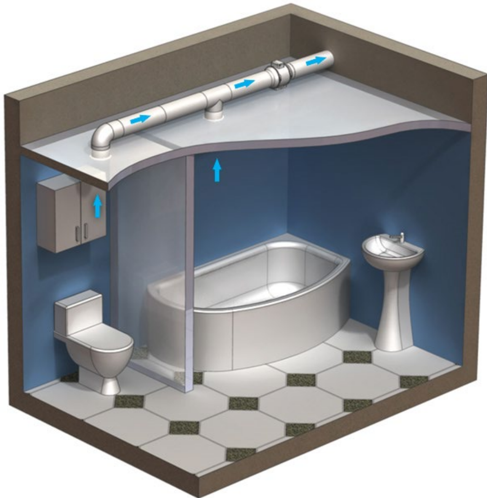
Рисунок 3.1 – місцева система вентиляції
