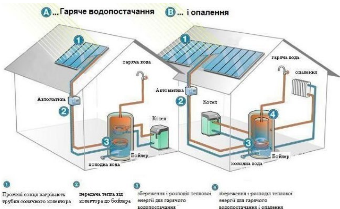
Рисунок 2.4 – Схема комплектування сонячних колекторів
