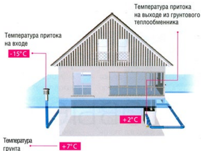
Рисунок 1.11– Схема роботи підземної вентиляції взимку
