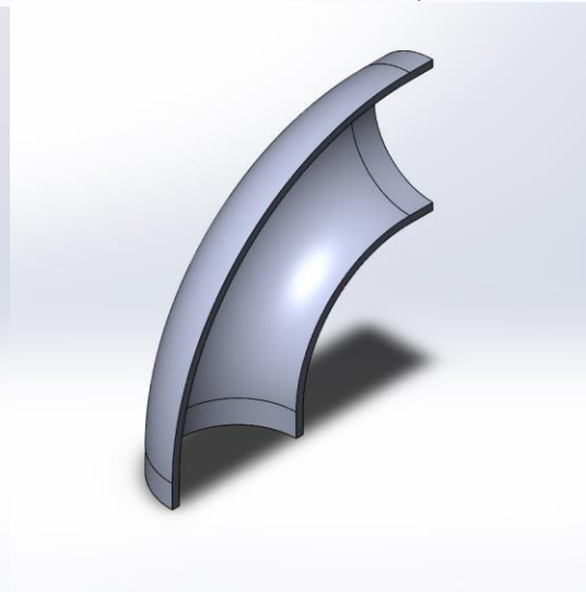
Рисунок 4.2 – Стадії моделювання відводу: а – створення ескізу з зовнішнім діаметром; б – створення ескізу з траєкторією; в – «бобишка по траєктории»; г – повздовжній переріз кінцевої моделі відводу
