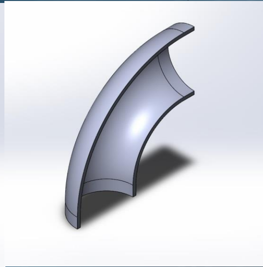
Рисунок 4.2 – Стадії моделювання відводу: а – створення ескізу з зовнішнім діаметром; б – створення ескізу з траєкторією; в – «бобишка по траєкториї»; г – повздовжній переріз кінцевої моделі відводу
