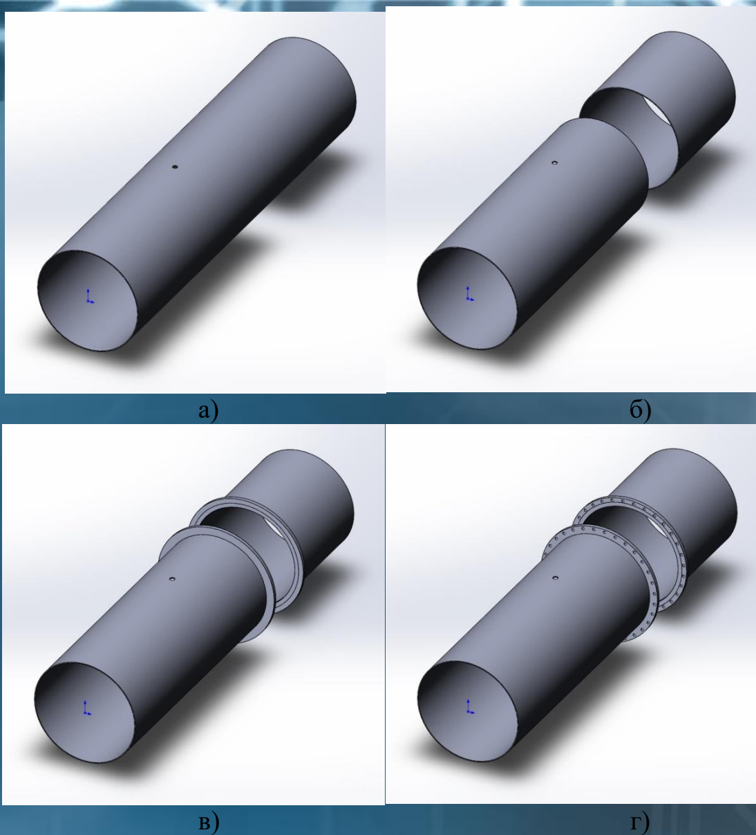
Рисунок 4.4 – Стадії моделювання трубопроводу з фланцевим з'єднанням: а – створення трубопроводу; б – виріз секції труби; в – створення основи фланця; г – створення отворів для болтових з'єднань
