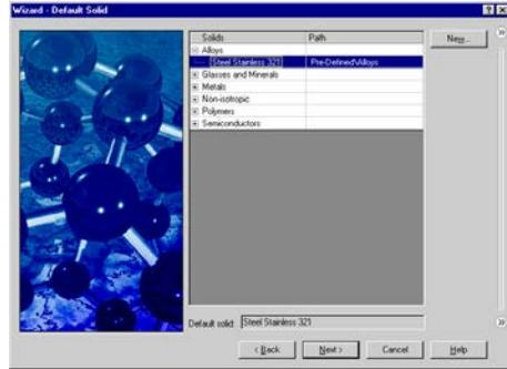
*Если к компоненту, посредством SolidWorks Materials Editor, ранее был присвоен твёрдый материал, вы можете импортировать этот материал в Flow Simulation и применить этот материал к компоненту в проекте Flow Simulation, используя опцию **Insert Material from Model** доступную в меню **Flow Simulation-Tools**.*
