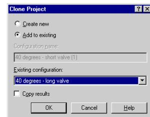
Новый, прикрепленный к конфигурации **40 degrees - long valve**, проект *Flow Simulation* имеет те же настройки что и старый, прикрепленный к конфигурации **40 degrees - short valve**, так что вы можете тут же начать вычисление.
