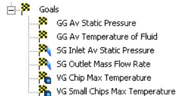
В этом примере инженерные задачи установлены для определения максимальной температуры теплогенерирующих компонентов, роста температуры воздуха, а также перепада давления и массового расхода в корпусе.
