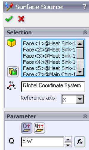
Следуя той же процедуре, создайте поверхностные источники с интенсивностью теплообмена 5 W на всей поверхности маленьких чипов.
