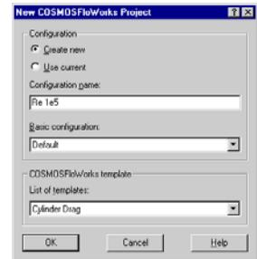
Созданный проект имеет те же настройки что и проект **Re 1000** с моделью **cylinder 0.01m**. Единственные отличия это разрешение геометрии (**Geometry Resolution**) и размер вычислительной области (**Computational Domain**), которые вычисляются в соответствии с новой геометрией модели.
