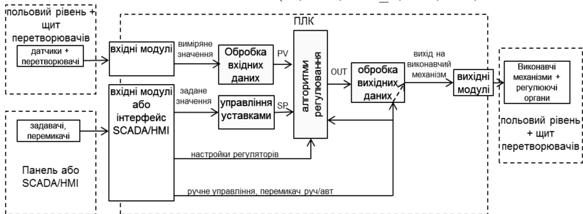
Рисунок 4.1– Структура контурів регулювання
