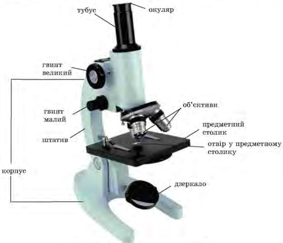
Мал. 26. Будова світлового мікроскопа
