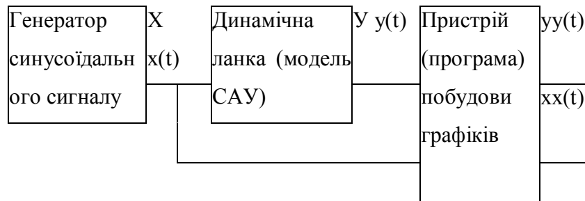
Рисунок 5.4 – Схема лабораторного обладнання для дослідження САУ
