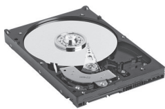
Рис. 3.2.3. Накопичувач на жорстких магнітних дисках
