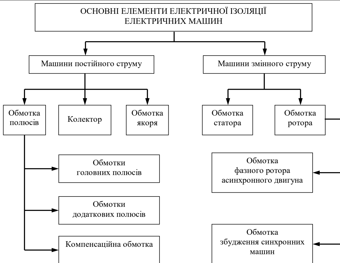
Рис. 3.1. Основні елементи електричної ізоляції електричних машин
