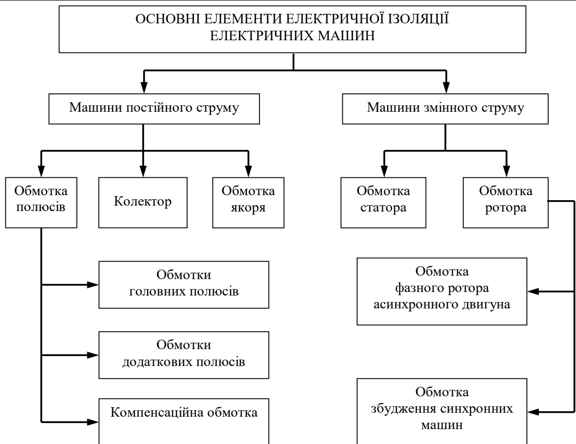
Рис. 3.1. Основні елементи електричної ізоляції електричних машин
