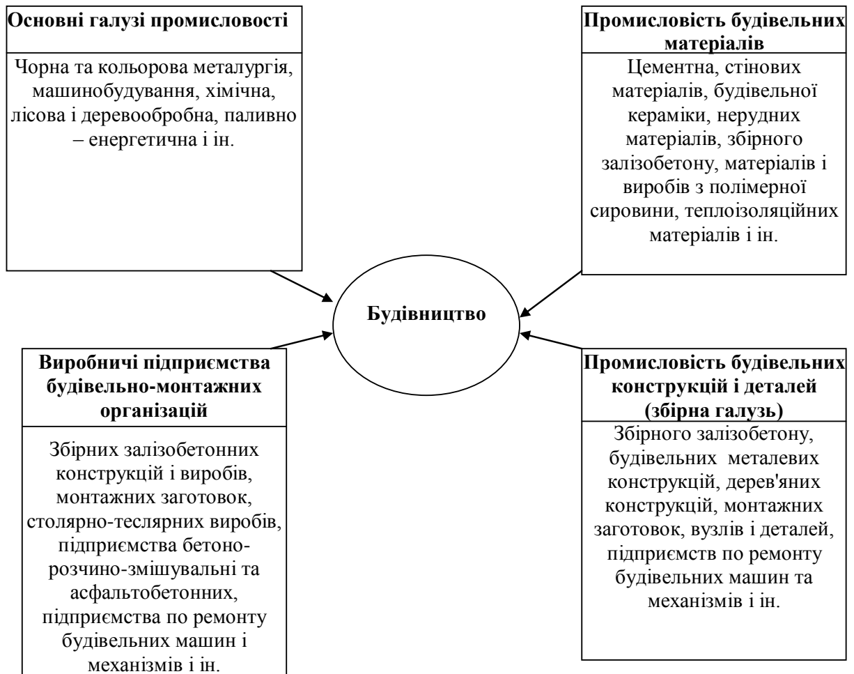
Рис.1.2. – Схема забезпечення будівництва матеріально-технічними ресурсами
