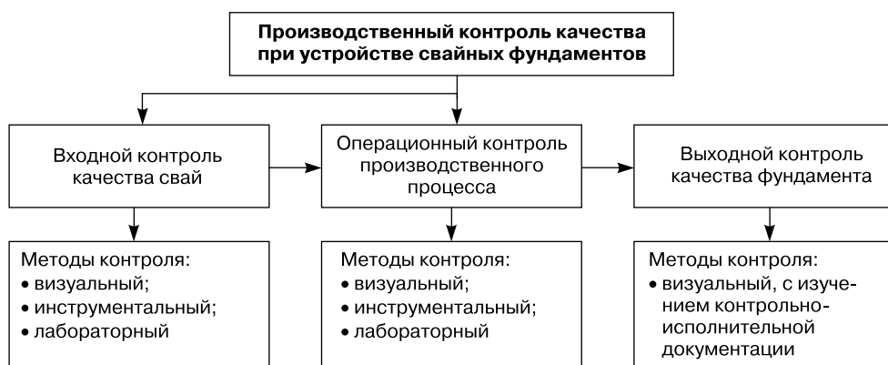
Рис. 10.7. Производственный контроль качества процесса «устройство свайных фундаментов» и методы определения дефектов
