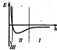
Рис. 9.7. Зависимость между энергией межмолекулярного взаимодействия и расстоянием между молекулами
