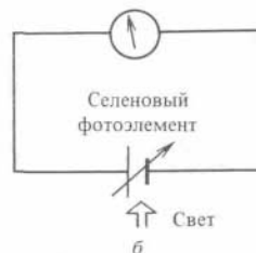
Рис. 9.4. Схемы электрических цепей экспонометров на основе фоторезистора (а) и селенового фотоэлемента (б).
