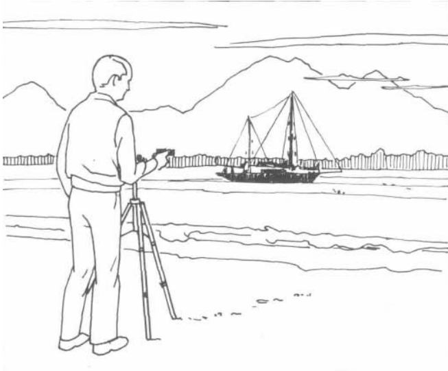
Рис. 9.2. Способ измерения экспонометром интенсивности отраженного света (по яркости)
