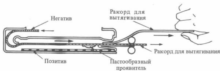
Рис. 7.15. Схема диффузионного процесса проявления
