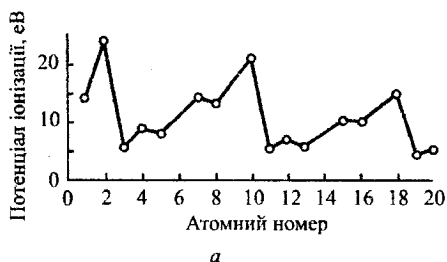
Рис. 1.6. Залежність енергії іонізації ізолюваних атомів від атомного номера – а; залежність енергії іонізації наночастинок натрію від кількості атомів у кластері – б.
