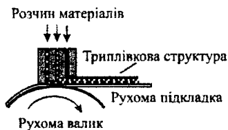
Рис. 10.30. Схематичне зображення реалізації методу одночасного формування багат шарових структур
