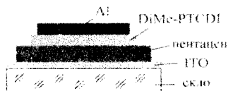
Рис.16.18. Схематичне зображення перерізу гетероструктури ITO/пентацен/DiMe-PTCDI/Al
