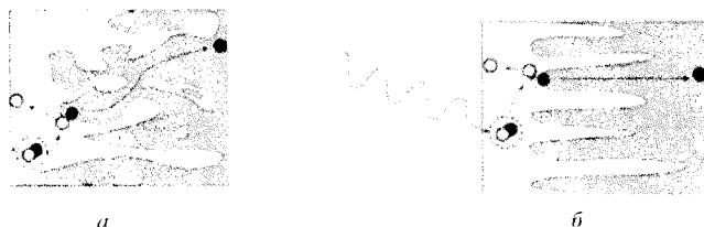
Рис. 16.7. Об'ємний гетероперехід ( а ) і впорядкований об'ємний гетероперехід ( б )
