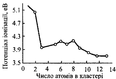
Рис. 1.6. Залежність енергії іонізації ізолюваних атомів від атомного номера – а; залежність енергії іонізації наночастинок натрію від кількості атомів у кластері – б.
