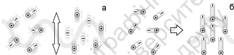
Рис. 4.5. Вплив електричного поля мікрохвиль на молекули: локальний розігрів унаслідок обертання диполів і поступального руху іонів (а). Орієнтація та поляризація молекул в електричному полі (б)
