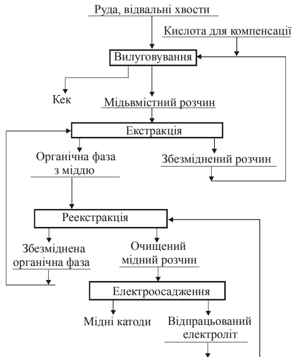
Рисунок 1.23 – Спрощена схема одержання міді за технологією «вилуговування–екстракція–електроліз»
