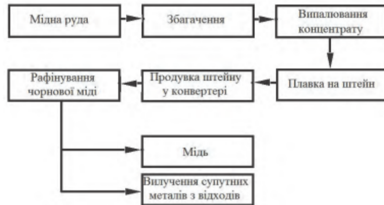
Рис. 1. Схема пірометалургійного процесу одержання міді.
