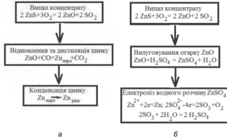
Рис.7.1. Схеми пірометалургійного (а) та гідрометалургійного (б) способів одержання цинку.
