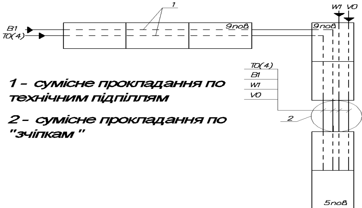
Рисунок 1 – Сумісний метод прокладання мереж по технічних підпіллям і "зчіпкам"
