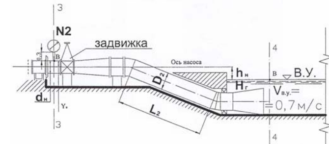
Рис. 10. Схема для определения показаний прибора 2
