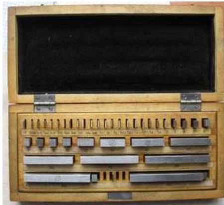
Рисунок 4.11 – Набір плиток Йогансона різної товщини
