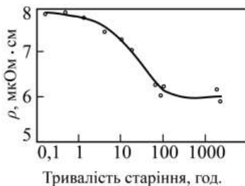
Рисунок 5.5 – Залежність питомого електричного опору сплаву АМг8 від тривалості штучного старіння при 150^\circ\text{C}
