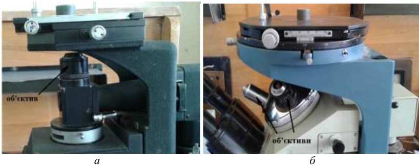
Рисунок 2.5 – Типи закріплення об'єктивів в металографічних мікроскопах: а – МИМ-7, б – ММР-2Р
