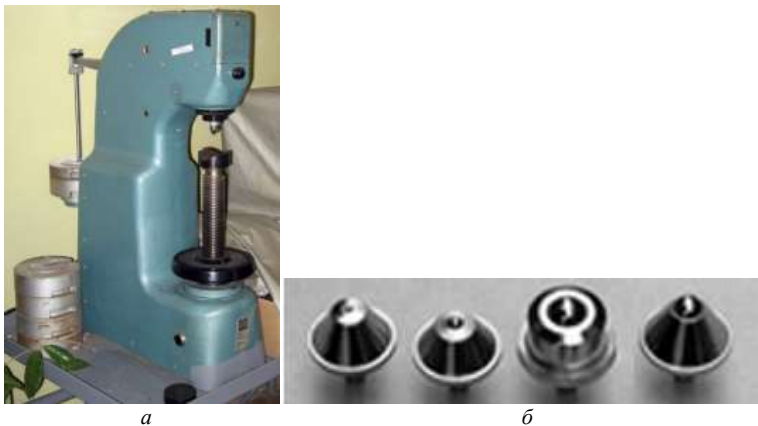
Рисунок 3.1 – Зовнішній вигляд твердоміра типу ТШ-2 ( a ) та форма інденторів ( б )
