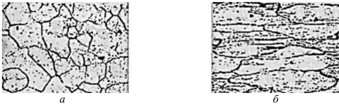
Рисунок 1.4 – Зміна структури заліза при пластичній деформації: a – вихідний стан; б – зміна форми зерен матеріалу при великій пластичній деформації
