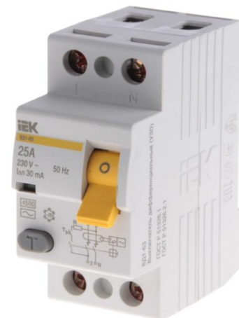
Пристрій захисного відключення (ПЗВ). Для вологих приміщень із порогом спрацювання 10 мА, для інших типів - 30 мА
