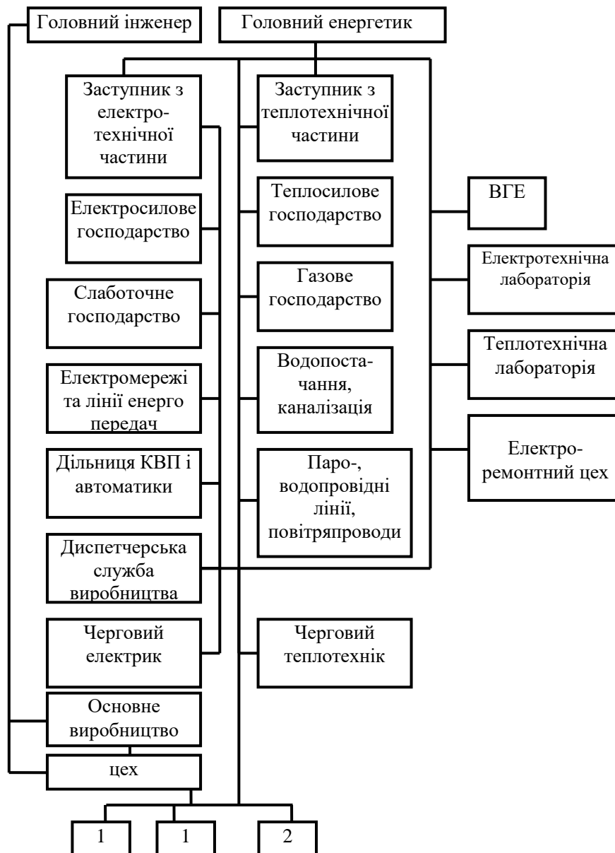
1 – черговий електрик цеху; 2 – черговий слюсар-ремонтник Рис. 3.8. Схема управління енергетичним господарством на промисловому підприємстві
