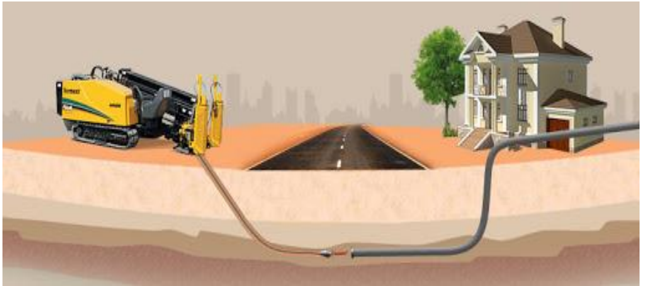
Прокладка труб методом прокола
