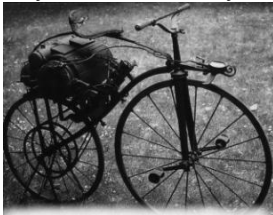
Паровелосипед конструкції Перро (1869 р.)
