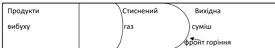
Рисунок 11.4 – Виникнення детонації газоповітряної суміші в трубі
