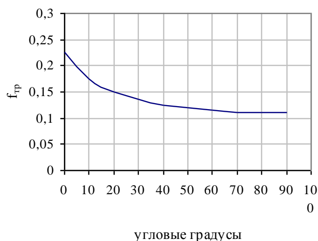
Рисунок 4.10 – Залежність коефіцієнтів тертя ВКМ на основі ВКН – 5000 (армований \pm 30^\circ ) від розташування поверхні тертя до напрямку армування
