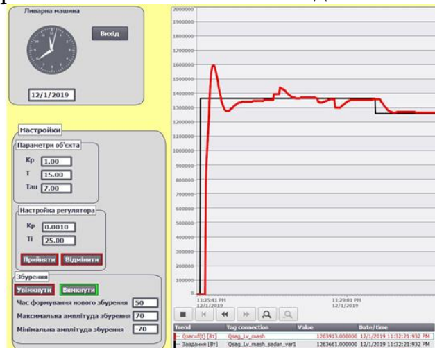
Рисунок 11.11 – Панель настроювання САР теплового режиму кристалізатора (а) та графік перехідного процесу при зміні завдання та під впливом випадкових збурень (б)
