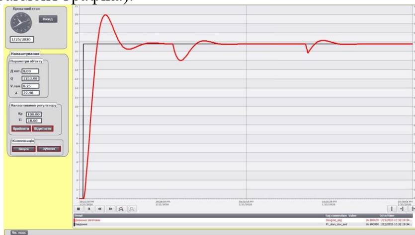
Рисунок 11.18 – Перехідні процеси в САР довжини заготовки
