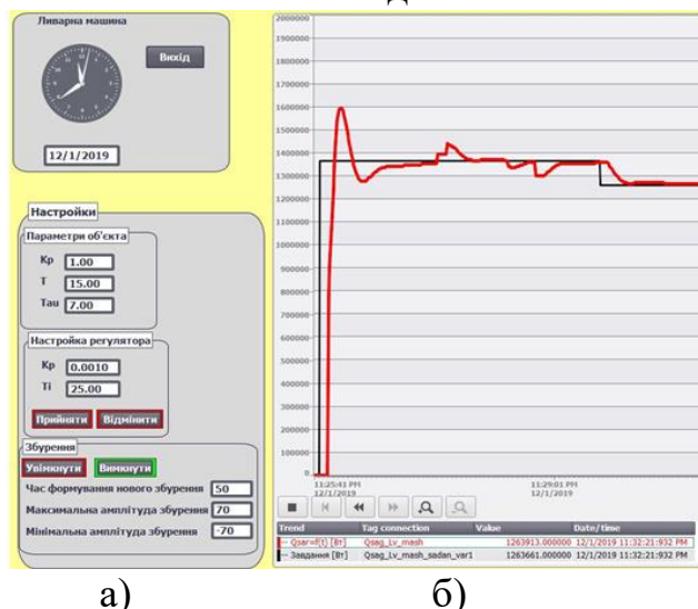
Рисунок 11.11 – Панель настроювання САР теплового режиму кристалізатора (а) та графік перехідного процесу при зміні завдання та під впливом випадкових збурень (б)
