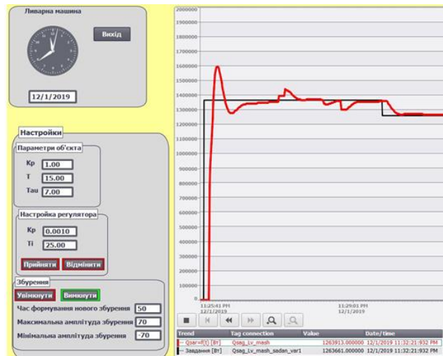
Рисунок 11 – Панель настроювання САР теплового режиму кристалізатора (а) та графік перехідного процесу при зміні завдання та під впливом випадкових збурень (б)
