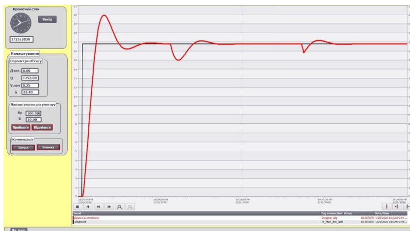
Рисунок 11.18 – Перехідні процеси в САР довжини заготовки
