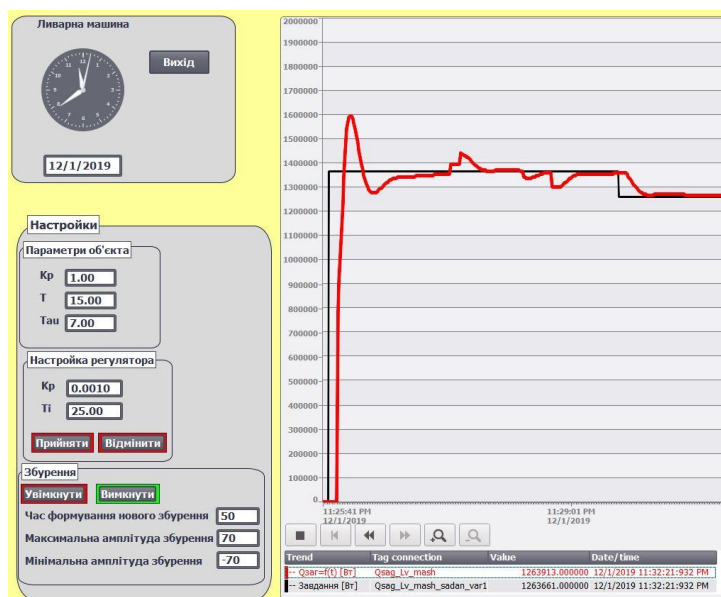
Рис.8. Панель настроювання САР теплового режиму кристалізатора (а) та графік перехідного процесу при зміні завдання та під впливом випадкових збурень (б)
