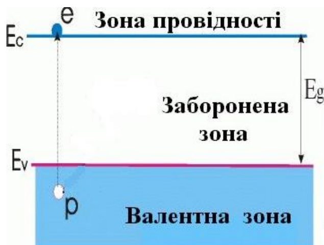
Рисунок 1.5 – Енергетична діаграма зон напівпровідника
