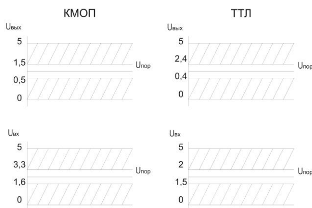
Малюнок 7.3 – Діаграми значень рівнів логічних «0» та «1» для мікросхем ТТЛ і КМОП логіки
