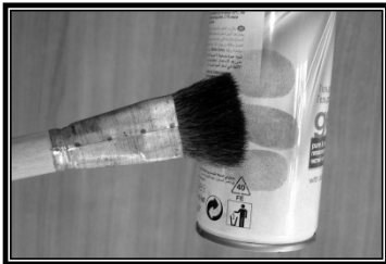
Рисунок 9.8 – Виявлення слідів рук немагнітним порошком
