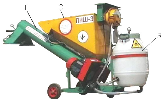
Рис. 5.1. Протруювач ПНШ-3: 1 – шнек; 2 – бункер; 3 – бак
