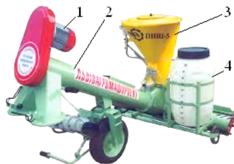
Рис. 5.2. Протруювач ПНШ-5: 1 – електричний двигун; 2 – змішувальний шнек; 3 – бункер; 4 – бак
