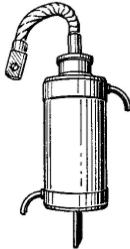
Рисунок 1.57 – Зовнішній вигляд суцільнометалевого ігнітрона
