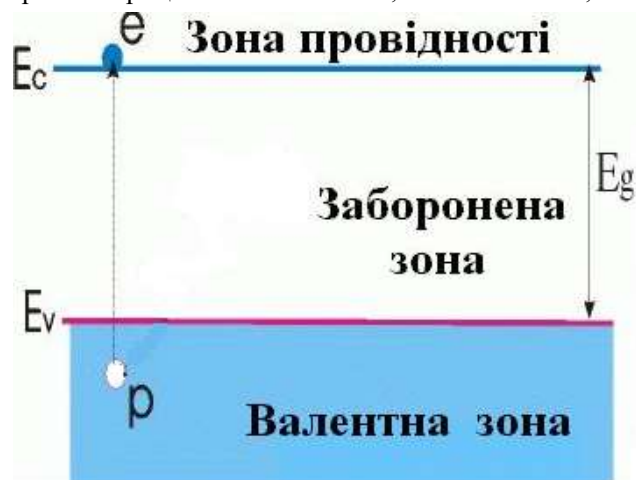
Рисунок 1.5 – Енергетична діаграма зон напівпровідника
