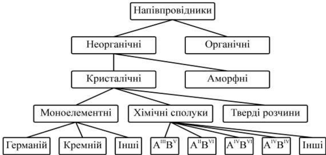
Рисунок 1.1 – Класифікація напівпровідникових матеріалів
