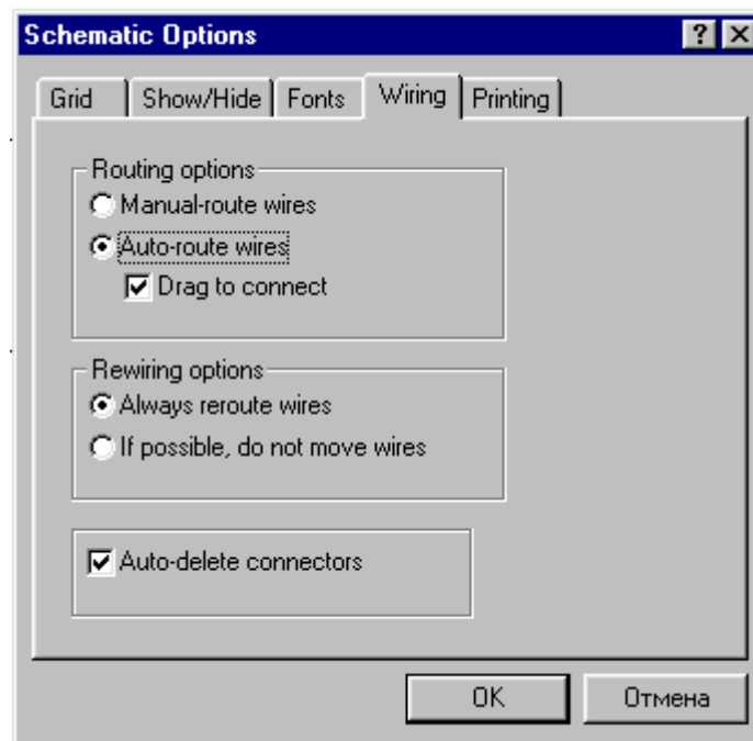
Рисунок 8.10 - Закладка Wiring для визначення режиму прокладки на схемі провідників
