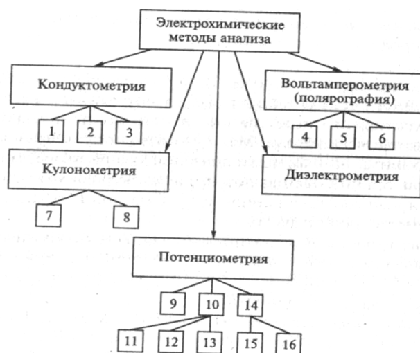
Рис. V.25. Классификация электрохимических методов анализа: 1 – прямая, 2 – косвенная, 3 – кондуктометрическое титрование, 4 – классическая полярография, 5 – исследование поляризационных кривых, 6 – амперометрическое титрование, 7 – потенциостатическая, 8 – гальваностатическая, 9 – редоксометрия, 10 – монометрия, 11 – рН-метрия, 12 – катионометрия, 13 – анионометрия, 14 – потенциометрическое титрование, 15 – прямое, 16 – дифференциальное
