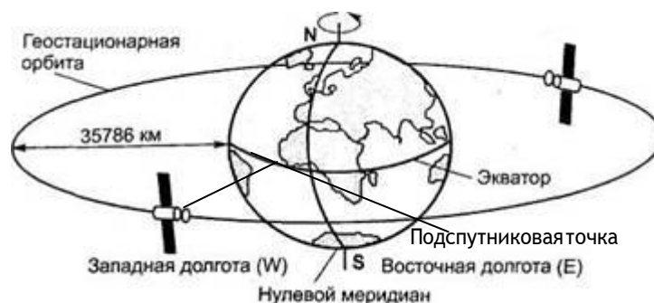
Рисунок 1.3 - Кутова швидкість обертання Землі і КА на геостаціонарній орбіті
