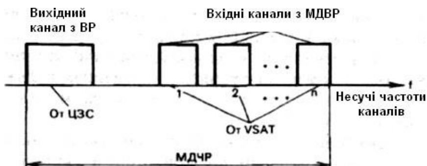
Рисунок 1. 37 - Багатостанційний доступ у мережах VSAT типу «зірка»
