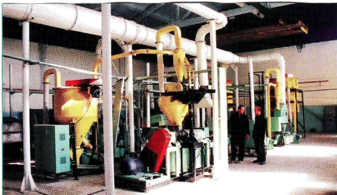
Рис. 2.6 – Лінія гранулювання переробки полімерних відходів плівки
