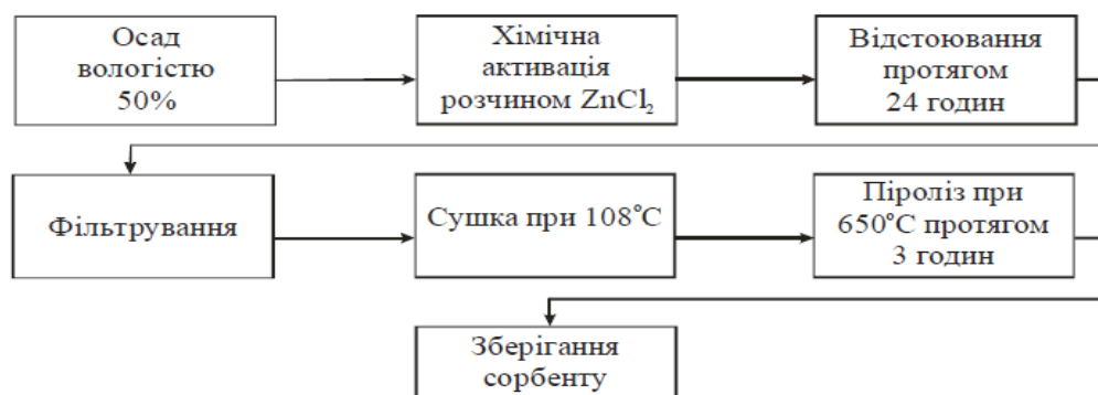
Рисунок 3 – Схема виробництва сорбенту з осаду муніципальних стічних вод
