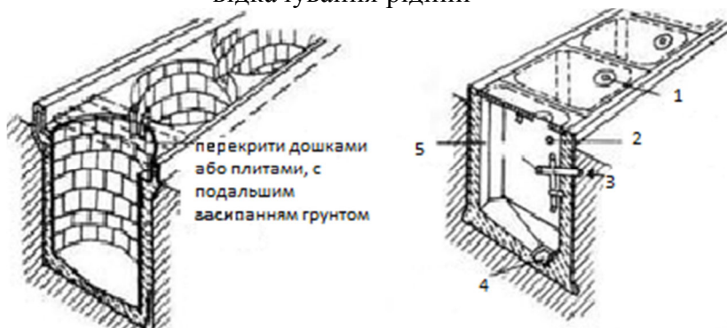
1 – асфальт-стальна труба, 2 – щільно закритий відстійник, 3 – місце для вмчерпування Цегляний або бетонний гноєзбірник з окремими відсіками та отворами для відкачування рідини
